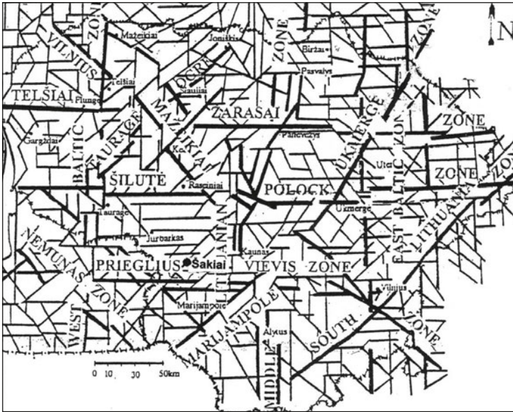
4 pav. Neotektoninių lūžių linijų svarbiausios zonos (regioniniai lūžiai – storos linijos, vietiniai lūžiai – plonos). S. Šliaupos ir M. Popovo kartoschema (1998)
