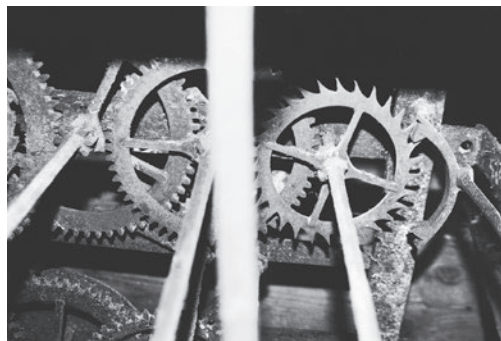
7 pav. Bokšto laikrodžio mechanizmas iš skalės pusės. 2002 m. L. Klimkos nuotr.
