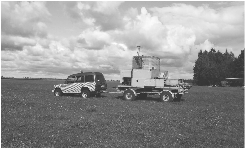
Automobilis su agregatu, naudojamu sklandytuvams iškelti į orą. Kartenos aerodrome 2013 m. G. Povilaičio nuotr. iš jo asmeninio rinkinio
