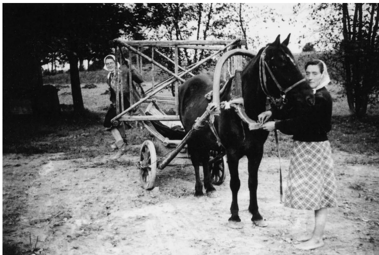
Vežimas (ratai) su uorėmis šienui (šiaudams) vežti
